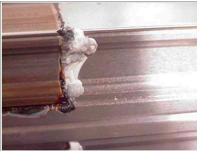
Verunreinigung des Schmiermittels durch Kunststoffabrieb auf der Führungsschiene
