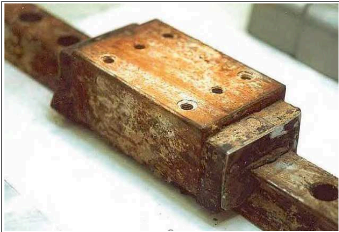
Korrodiertes Führungswagen bei einem Extremtest unter Kühlschmierstoff
